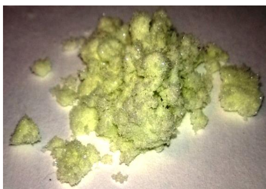
Рисунок 39 – Фотография кристаллов ГХА, полученных при охлаждении раствора до 0 °С.
